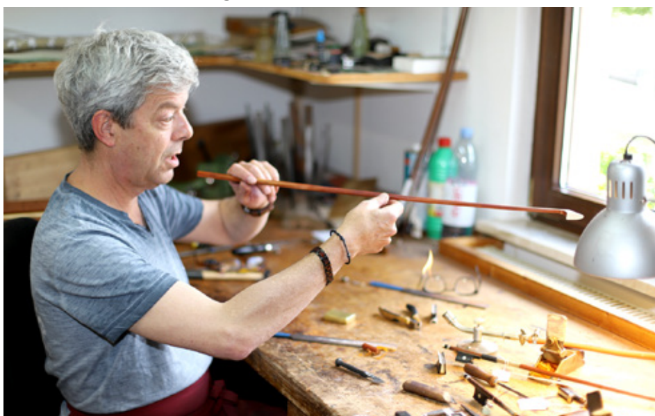
Das Biegen der Stange über einer Spiritusflamme.
